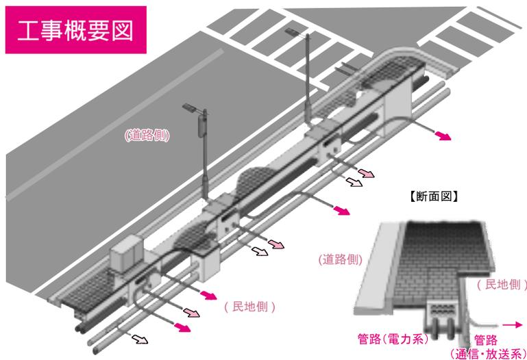
矢印で示している民地への引き込み線を NTT・九州電力の工事にて行います。
