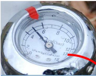
水を入れたペットボトルに空気を入れて圧力かける。今回は100mの奥行きが取れるグラウンドなので、1.5ℓのペットボトルでこの割合。もっと距離を取れる場合8(bar)にすることもある。逆に狭い会場なら500ミリリットルのペットボトルを使い飛距離を短く調整することもあるそう。
