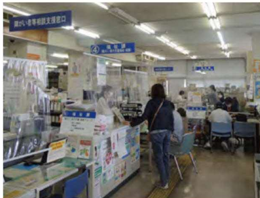
点字ブロック付近に什器が配置されているため、目の不自由な方の通行の妨げになっている
