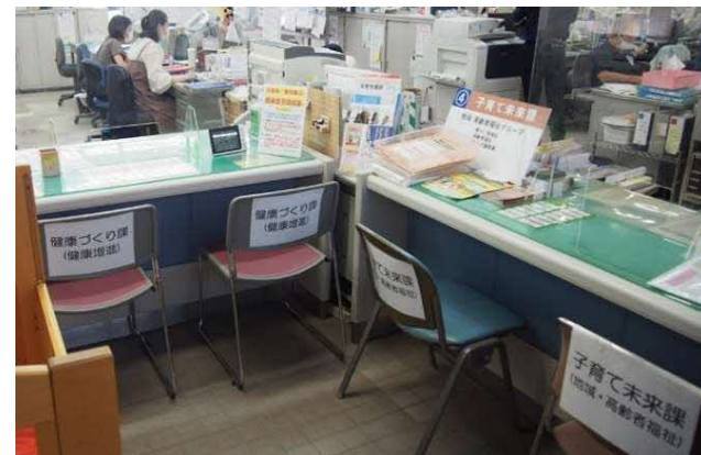
入隅にある住民窓口は片方が利用しにくい
