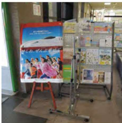
サイン本体の足が車椅子・ベビーカー等の通行の障害となり危険性がある
