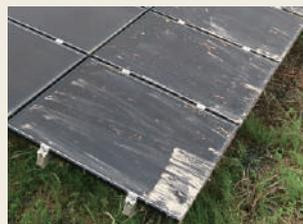
事例② 自然災害による故障 (水害で浸水したパネル)
