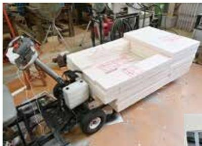
JR九州からの依頼で、かもめを模したミニトレインを製作しています。駆動部にはシニアカーを活用し、後部車両は、角棒を溶接してフレームを作り、車軸を取り付けました。
